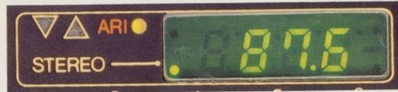
Das Display des Bremen SQR 32: Leuchtdioden für die Anzeige der Senderfrequenz sowie für ARI und Stereo.
