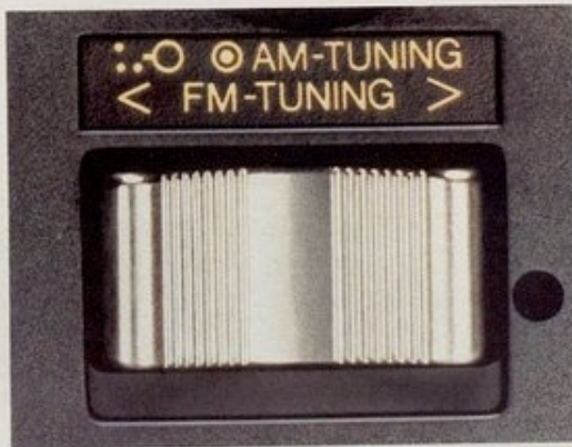
Die Wippe für den Sendersuchlauf in beiden Richtungen: Antippen genügt – schon sucht der Mikrocomputer einen neuen Sender und stimmt ihn optimal ab.
