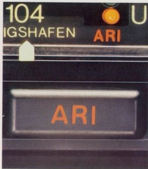
Bei gedrückter ARI-Taste empfängt das Gerät ausschließlich Verkehrsfunksender.
