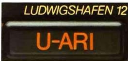
Bei gedrückter ARI-Taste empfängt das Gerät ausschließlich Verkehrsfunksender.
