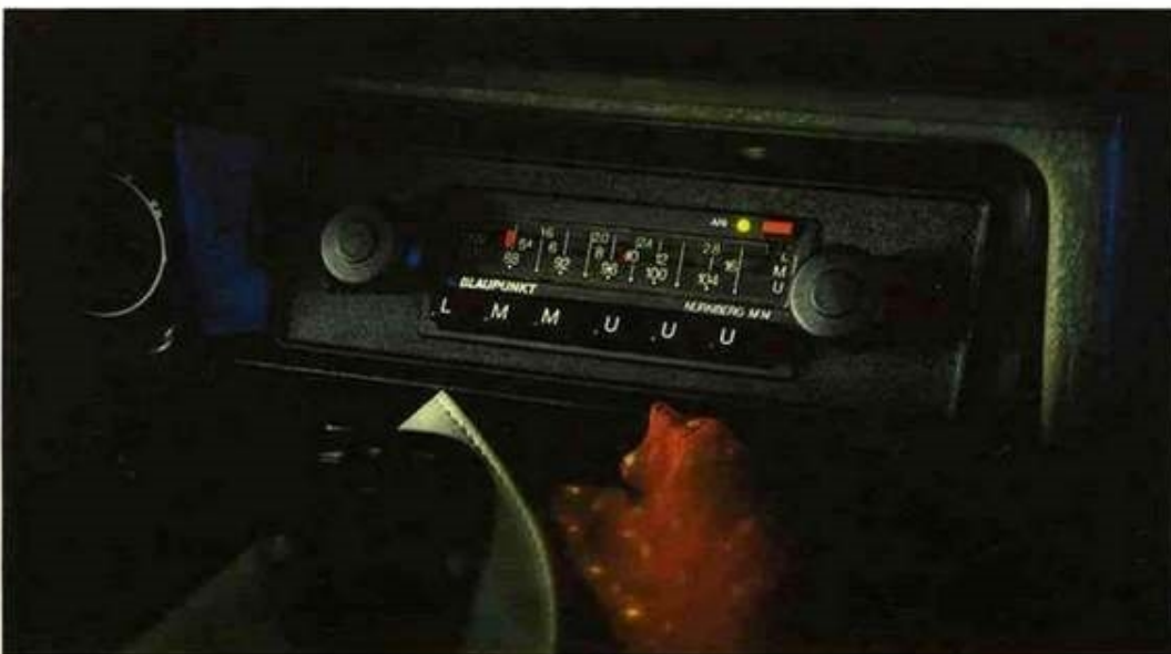
Stationstasten zum Abrufen der gespeicherten Sender.
