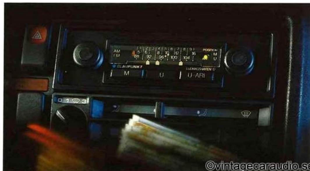
Bei gedrückter ARI-Taste empfängt das Gerät ausschließlich Verkehrsfunksender.
