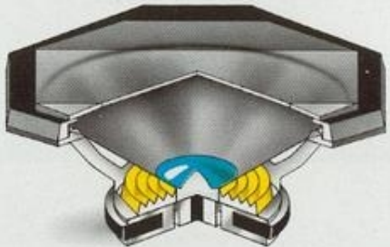
Breitband-System (Single-System): eine Membran zur Abstrahlung des gesamten Übertragungsbereichs.
