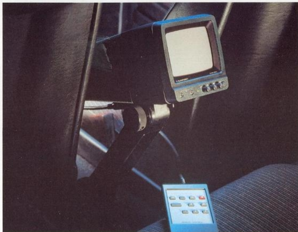
Kompakt und komfortabel: 4 1/2"-InCarVideo-Monitor mit 11cm-Farbbild, Fernsteuerung aller Recorder Funktionen.
