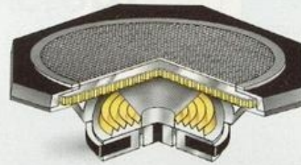
Honeycomb-System: Flachmembran mit Wabenstruktur.
