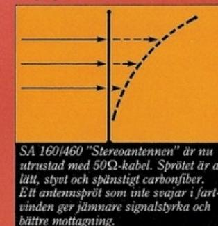
SA 160/460 "Stereoantennen" är nu utrustad med  $50\Omega$ -kabel. Spröret är av lätt, styvt och spänstigt carbonfiber. Ett antenspröpt som inte svajar i fartvinden ger jämnare signalsstyrka och bättre mottagning.
