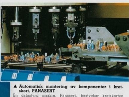
▲ Automatisk montering av komponenter i kretskort, PANASERT
