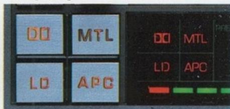
Unterdrückung des Bandrauschens. Der Bandsorten-Schalter (MTL) ermöglicht die typgerechte Entzerrung von Normal-, CrO<sub>2</sub>- und Metallbändern. Durch die Loudness-Schaltung wird auch bei geringen Lautstärken voller Klang ermöglicht. Die separate Bass- und Höhenregler ermöglichen die Gestaltung eines Klangbildes nach Ihrem persönlichen Geschmack.
