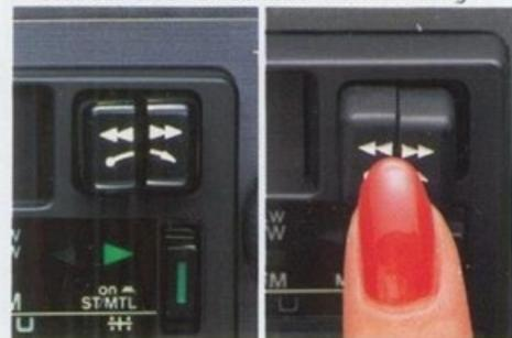
Ist das Bandende erreicht, wird die Laufrichtung des Bandes umgekehrt und die zweite Bandseite abgespielt. Einrastende Tasten für schnellen Vor- und Rücklauf erhöhen ebenfalls die Fahrsicherheit. Zum Auswerfen der Cassette werden beide Tasten gleichzeitig gedrückt.
