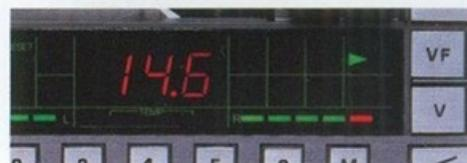
Drücken Sie die Taste V, und die von der Fahrzeugbatterie gelieferte Spannung wird angezeigt. Bei
