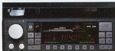
und Cassettenauswurf sind alle Bedienelemente Electronic-Schalter, die eine flache Frontplattengestaltung ermöglichen. Ein leichtes Klicken signalisiert Ihrer Fingerspitze beim Antippen der Electronic-Tasten, daß der Schaltvorgang ausgeführt ist.
