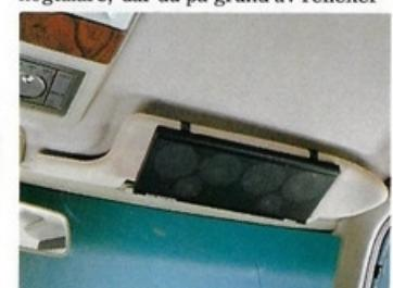
saknar mellan- och diskantregister, bör denna typ av kompletterande högtalare användas. Skall om möjligt monteras på ett sådant sätt att direktljud erhålls.
