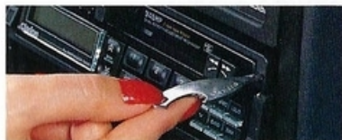
• Stereon sitter låst i fästet. Använd specialnyckeln för att koppla ur låset och dra sedan i handtaget.
