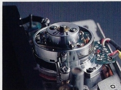
Clarion har utvecklat den avancerade trumman med tonhuvudet speciellt för bilar. Konstruktionen, som spårar det 13,6 mikron breda spåret helt exakt, är hjärtat i DAT-däcket.
