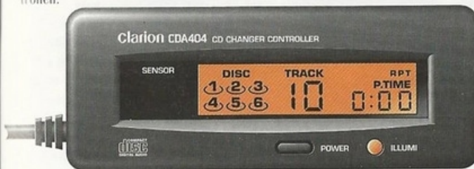
CDA404 Ansluts till bilradions lågnivåutgång eller kopplas direkt till separat slutsteg.
