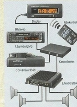
CDA404 Ansluts till bilradions lågnivåutgång eller kopplas direkt till separat slutsteg.
