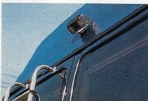
CC830G monterad ovanför bakdörrarna på en Van. Linsskyddet fälls upp först när backen läggs i och håller linsen ren vid färd.
