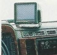
Monitorn innehåller ett 90 graders svart/vitt bildrör av konventionell typ. Monitorn kan antingen startas manuellt med hjälp av en knapp eller automatiskt när man lägger in blicken eller sätter på blinkers. Det finns möjlighet att justera ljus och kontrast samt manuellt eller automatiskt inställning för bildens ljusstyrka.
