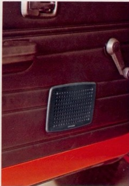
Einbaulautsprecher L/U 19 und L/U 23 (L/U 23 ohne Abbildung) Nennbelastbarkeit 5 W Musikbelastbarkeit 7 W Übertragungsbereich 75... 12500 Hz Grill L/U 19 = ca. 165 x 110 x 5 mm; zusätzlich 46 mm für Einbautiefe erforderlich. Grill L/U 23 = ca. 112 x 112 x 5 mm; zusätzlich 48 mm für Einbautiefe erforderlich.
