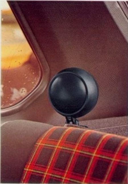
Kugellautsprecher L/U 18 mit verstellbarem Abstrahlwinkel! Nennbelastbarkeit 15 W Musikbelastbarkeit 25 W Übertragungsbereich 100... 12500 Hz Höhe mit Fuß = ca. 148 mm, Kugeldurchmesser = ca. 118 mm.
