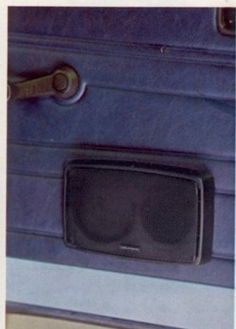
Einbaulautsprecher L/U 80 Nennbelastbarkeit 20 W Musikbelastbarkeit 30 W Übertragungsbereich 63... 20000 Hz Maße: ca. 205 x 33 x 125 mm; zusätzlich 58 mm für Einbautiefe erforderlich. Geschlossene Zweiweg-Box! Liefert... Sommer 1988
