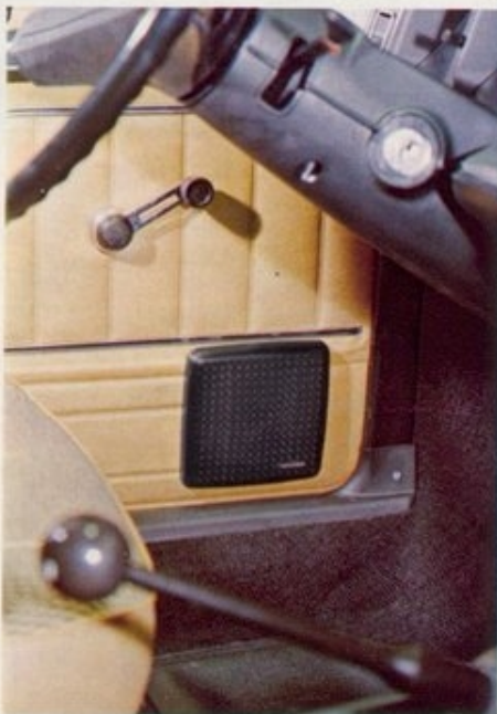
Einbaulautsprecher L/U 21 Nennbelastbarkeit 5 W Musikbelastbarkeit 7 W Übertragungsbereich 80... 12500 Hz Grill – ca. 142 x 142 x 18 mm; zusätzlich 37 mm für Einbautiefe erforderlich.
