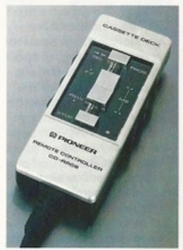
Fjärrstyrningsenheten CD-R 909 har: FF, FF Music Search (tryck två gånger), REW, REW Music Search (tryck två gånger) och STOP (kassettmekanismen stoppar när denna knapp trycks in).
