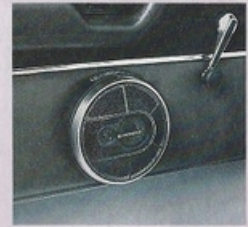
AD-M16 mellanring plus TS-168 i infälld monteringen i en framdörr.
