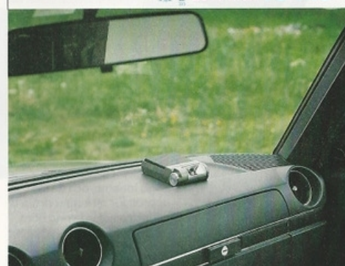
TS-M6 monterad på instrumentpanelen med hjälp av dubbellämfästande tejp.
