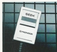
Fjärrstyrning för stationsinställningen.
