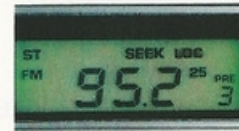
Multi-informationstabla av LCD-typ visar : våglängdsområde, frekvens, stereo, stationssökning, lokalsändare, minne, förvalsnnummer.
