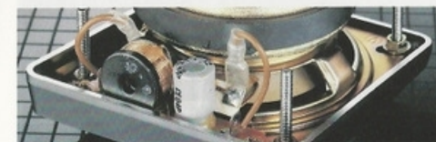
BILDTEXT: TS-T3-tweeter har inbyggt delningsfilter som skär bort alla lägre frekvenser under 250 Hz.
