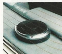
TS-202 60W högtalare, infällt montage på bakre hatthyllan och med användning av extra vinkelbrickor (som levereras tillsammans med högtalarna).
