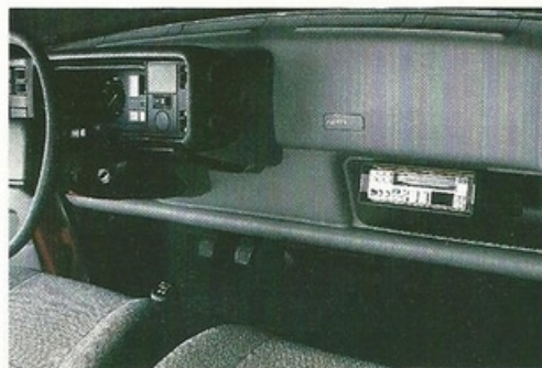
KP-007 komponentkassettdäck monterat i en AD-110 underhångsmonteringssats.
