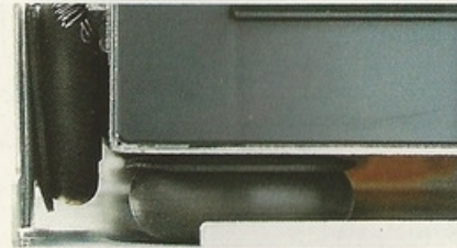
Ett dubbelt flytande system skyddar enheten mot stötar och vibrationer.
